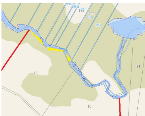
Ryc. 19 Obszary zagrożenia powodzią nad rzeką Czarna Hańcza w obrębie Czarnakowizna (kolor żółty 0,2% raz na 500 lat, kolor niebieski 1% raz na 100 lat)
